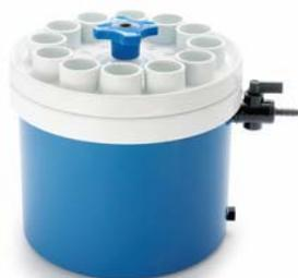
Система 1225 фильтрует до 12 индивидуальных образцов в 15 мл пробирки
